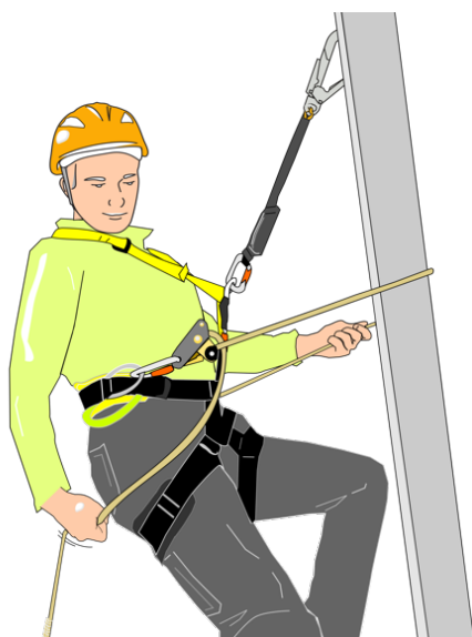
Double assurage au poste de travail lors de l’appui contre la corde de positionnement (image absturzrisiko.ch)
